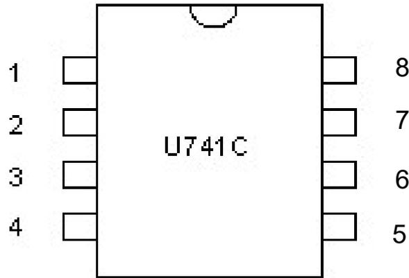
圖 6 運算放大器針腳示意圖
