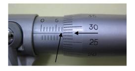
主尺:7mm、副尺 0.01mm\*28=0.28mm,量測值物:7mm+0.28mm=7.28mm
